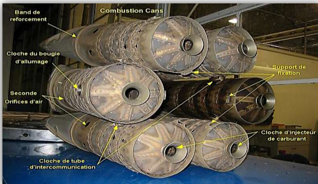
Figure (1.7) : le système de combustion.
