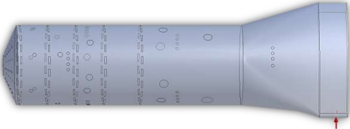
Figure (3.2) : la chambre de combustion de l'Allison-T56 sous le logiciel ANSYS Design Modeler.
