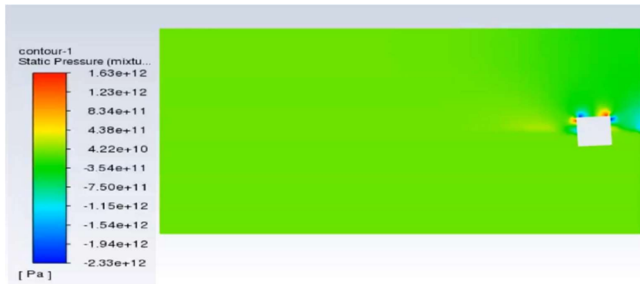
Figure III.1 Pression statique en (Pa) pour différentes géométries de pion
