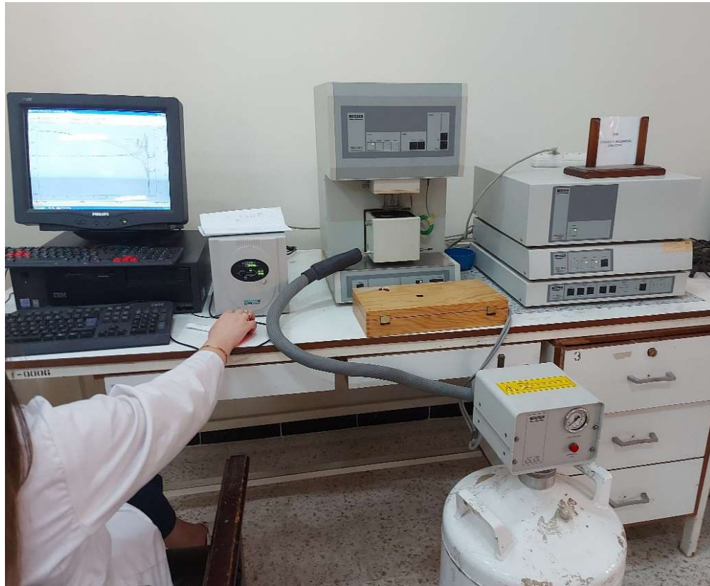
Figure I.11 : Appareil de l'analyse Mécanique Dynamique DMA
