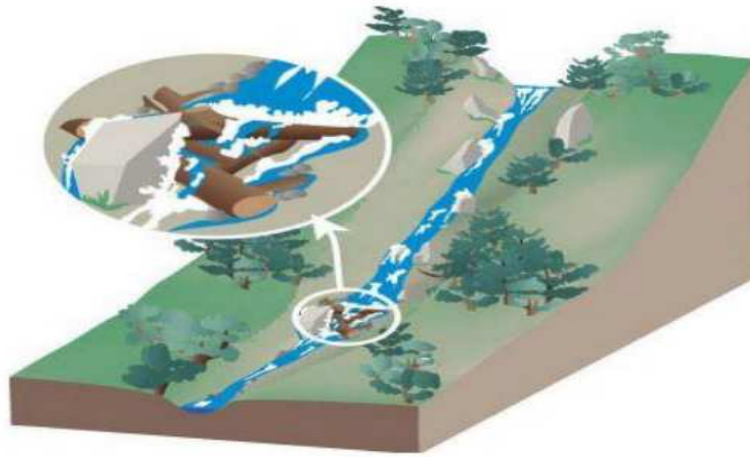
Figure I.2 : Embâcle sur un torrent, inondation par crue torrentielle.
