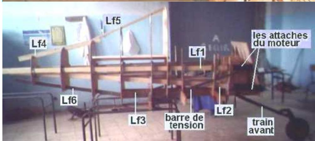
Fig. (V-11) Les longerons du fuselage
