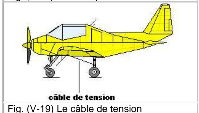
Fig. (V-19) Le câble de tension
