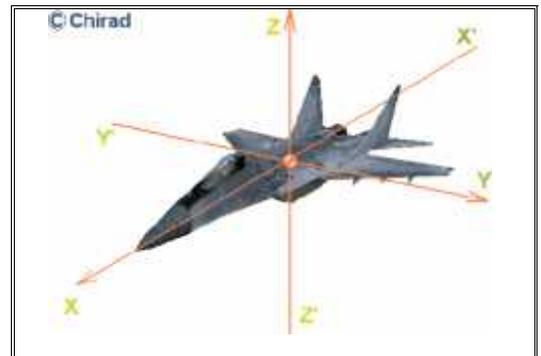
Fig.(IV-1): Les axes d'un avion
