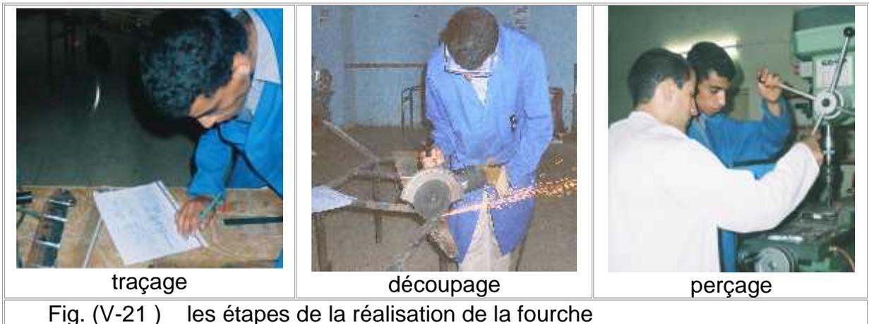
Fig. (V-21 ) les étapes de la réalisation de la fourche
