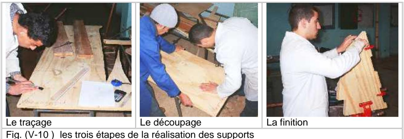
Fig. (V-10 ) les trois étapes de la réalisation des supports
