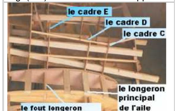
Fig. (V-7) Les cadres du cockpit c,d,e.
