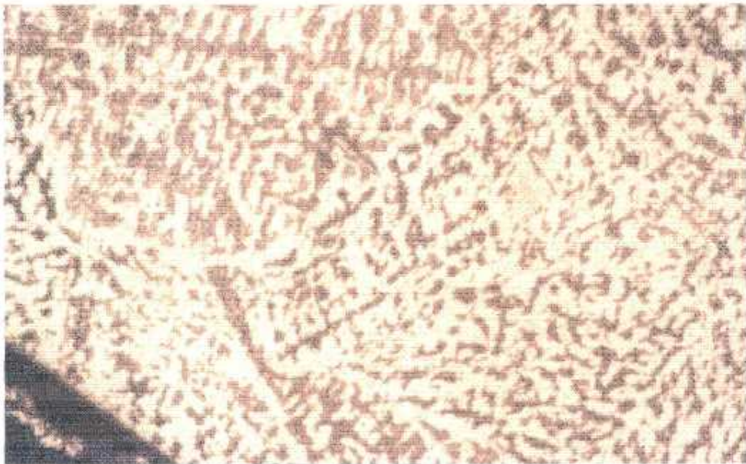
Fig 27 : Structure homogène en présence du Manganèse (x 100)
