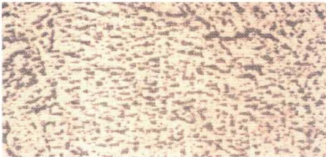
Fig 37 : AG2M1 Structure plus affinée après TT (x200) Après 4h de revenu
