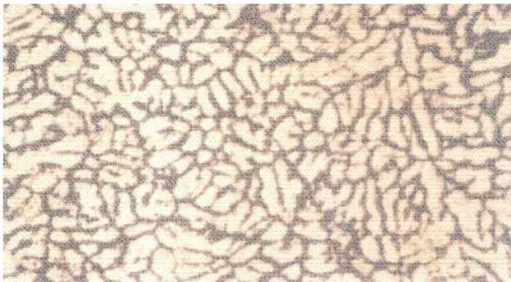
Fig 37 : AG2S0,9 Fractionnement de dendrites (x 100) Après 6h de revenu
