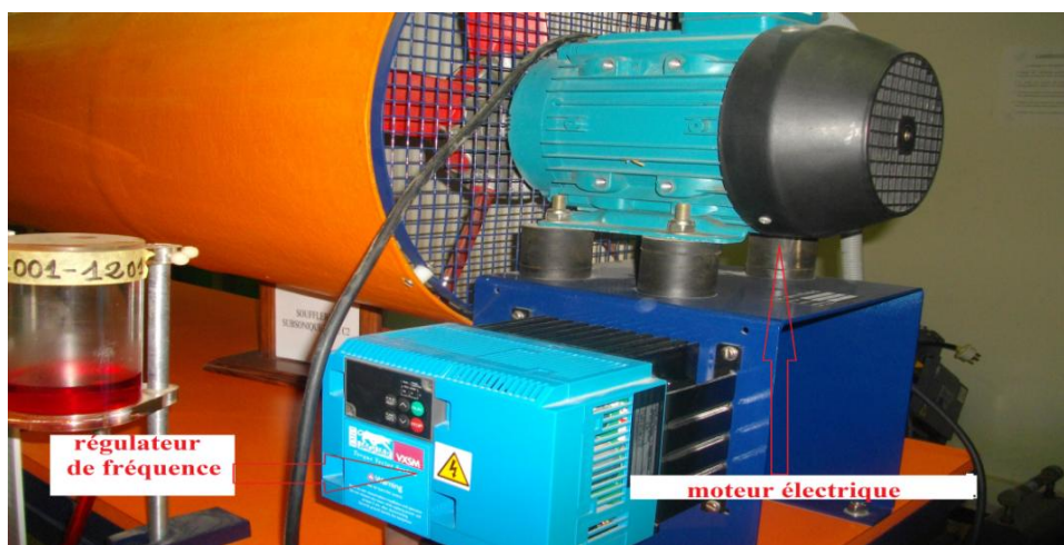
Figure. 2.12. Moteur électrique de la soufflerie.
