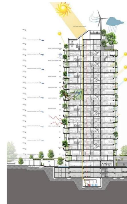
Figure 65: coupe schématique de l'approche énergétique
