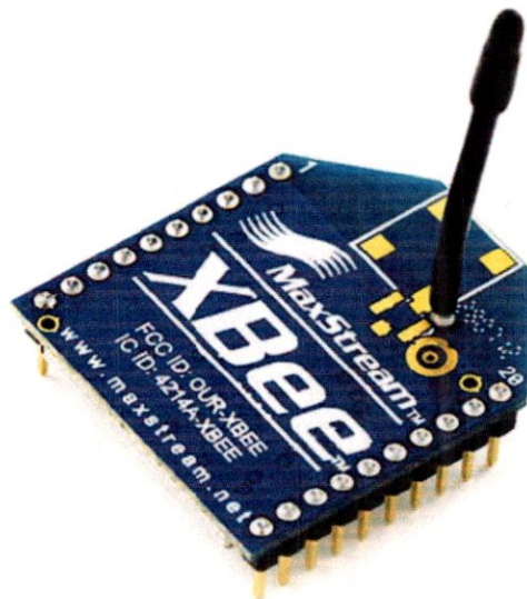
Figure 2.10 - le module wifi sans fil XBee 802.15.4 de 1mW.
