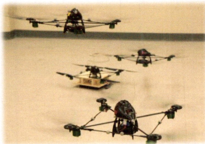
Figure 1.26 - Une manœuvres des GRASP quadri-rotors avec atterrissage sur la station de recharge
