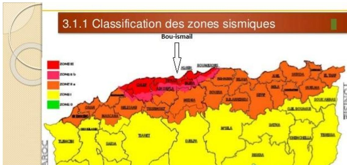
Figure 20:classification des zones sismiques Algérie
