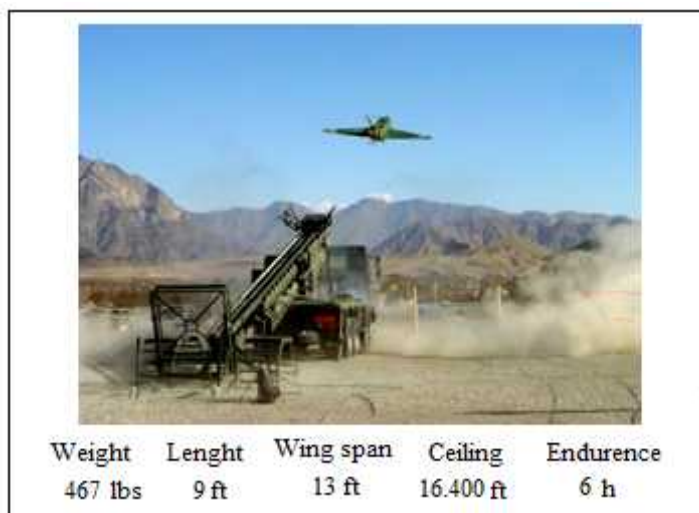
Figure. I.2 Catapultage opérationnel d'un Sperwer
