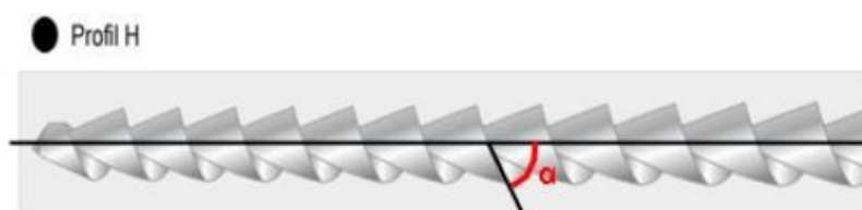
Figure 35 : l'angle d'hélice d'une lime H
