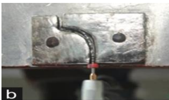
Figure 68 : exemple de dispositif expérimental simulant un canal artificiel.
