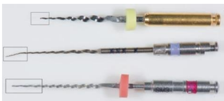
Figure 53 : Défauts de rotation Signalés sur des instruments Ni-Ti aboutant à une fracture imminente.
