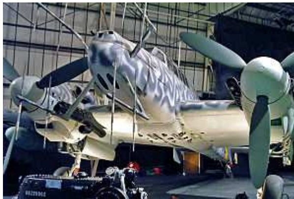
FIGURE 1.1: Un radar Lichtenstein SN-2 monté sur un chasseur allemand Bf 110.
