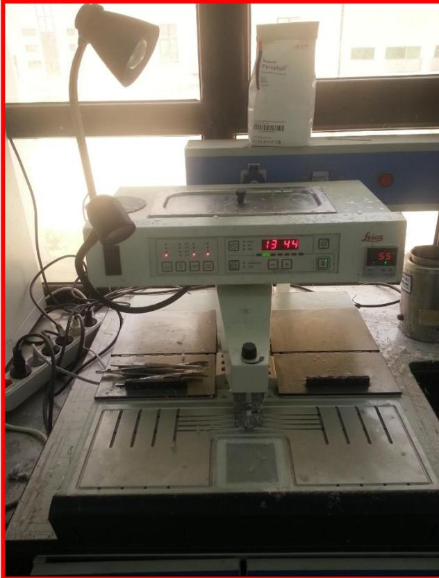
**Photo 1:** Module chauffé de distribution de paraffine (Photo personnelle).
