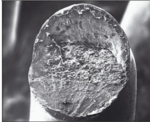
Figure 14:Image électronique secondaire d'un fil orthodontique fracturé [98]
