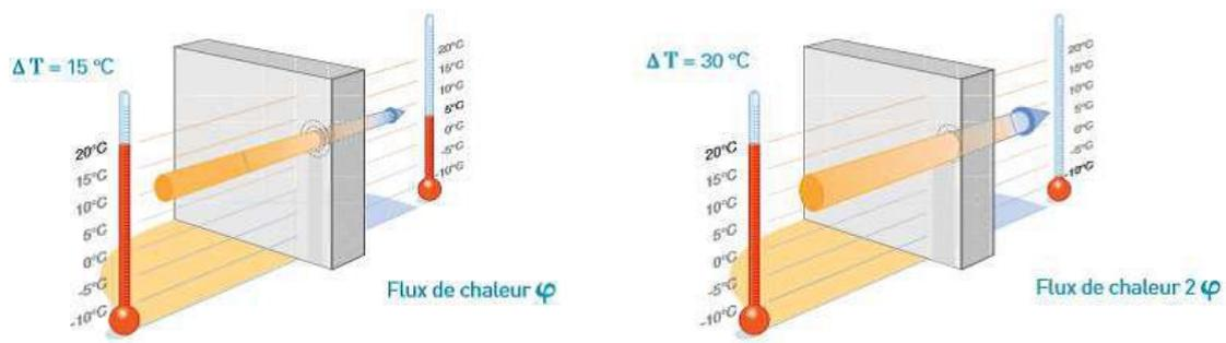
**Figure 1.16** : flux de chaleur dans le mode chaud et froid [18]
