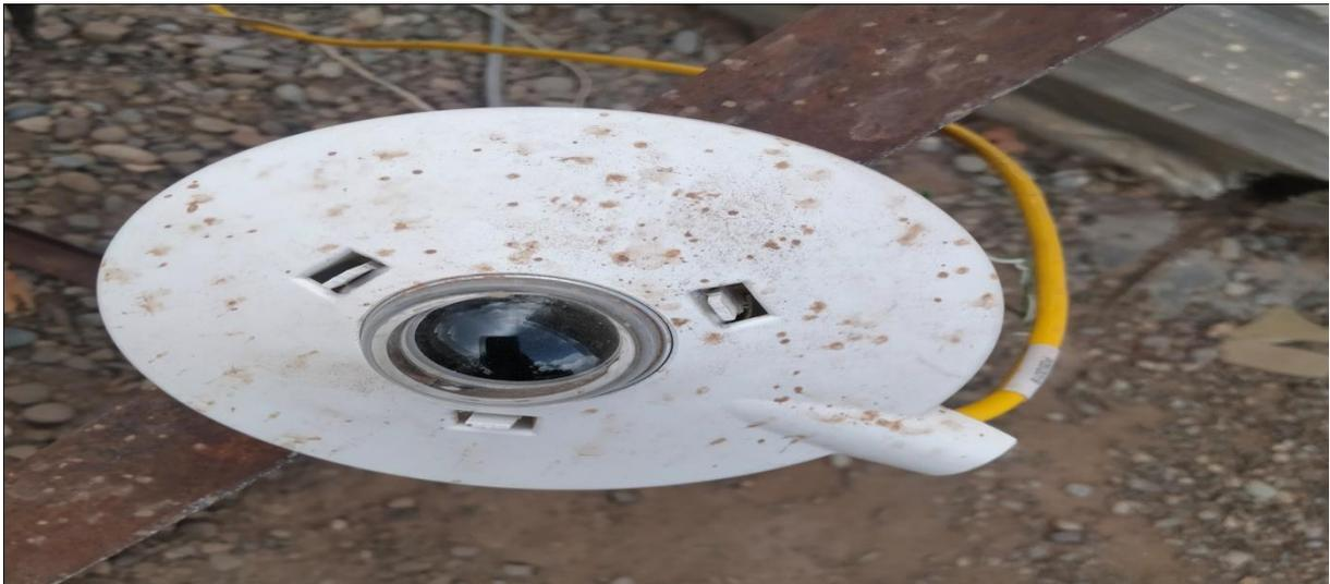
**Figure III.9.***un pyranomètre*
