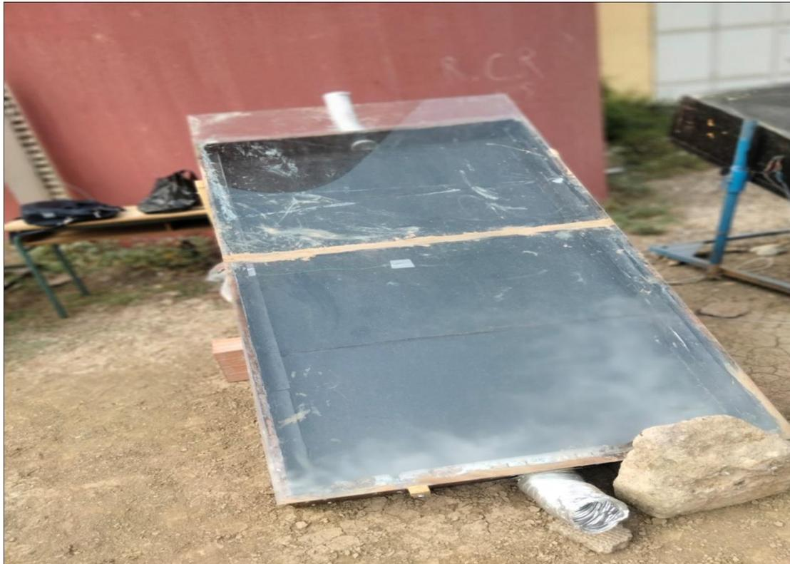
**Figure (II-7) :** photo représente le capteur solaire réalisé fini
