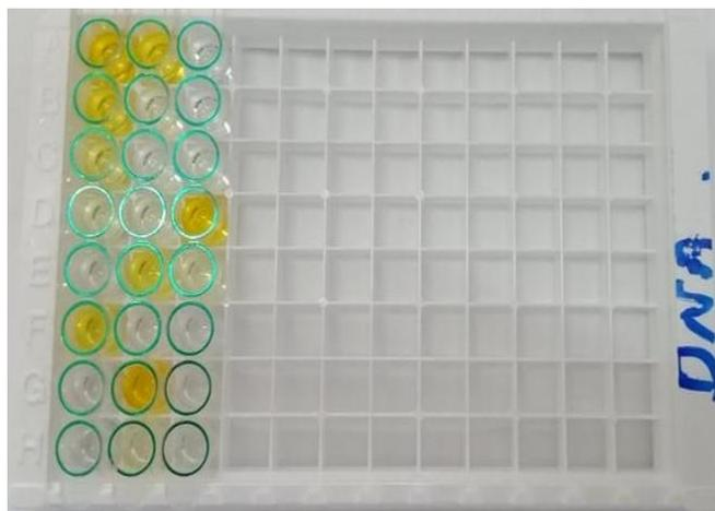
**Figure 6 : microplaque ELISA sensibilisée pour l'identification de l'anti-ADN**
