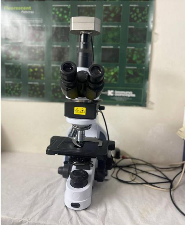
**Microscope à fluorescence pour l'IFI**
