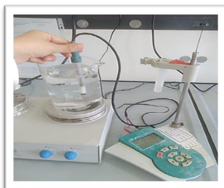
Figure 31 : Ajustement du pH par l'acide orthophosphorique.
