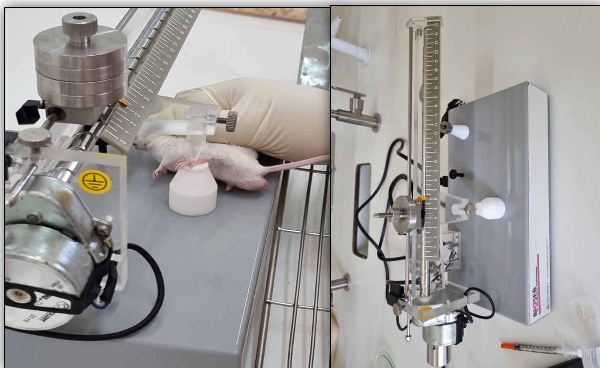
Figure 50 : Appareil d'Algomètre employé pour la mesure pourcentage d'analgésie
