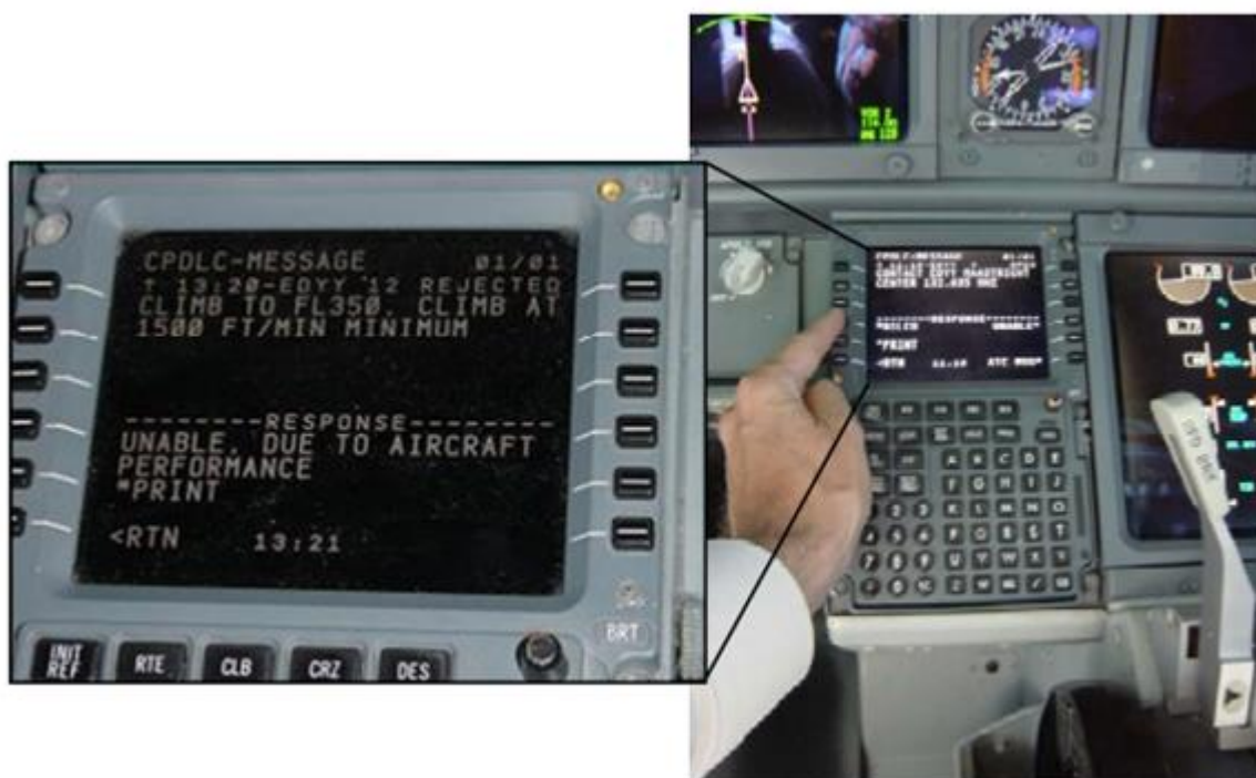
Figure II-2 Interface du pilote pour les messages CPDLC
