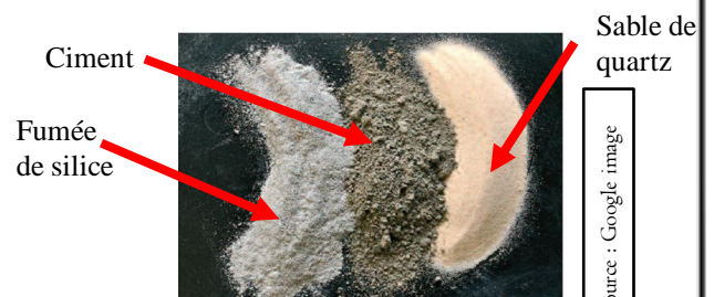
Fig 85. Composants d'un BFUP
