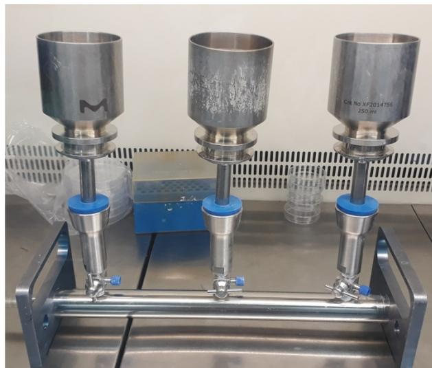
**Figure 21 :** Unité de filtration à membrane.
