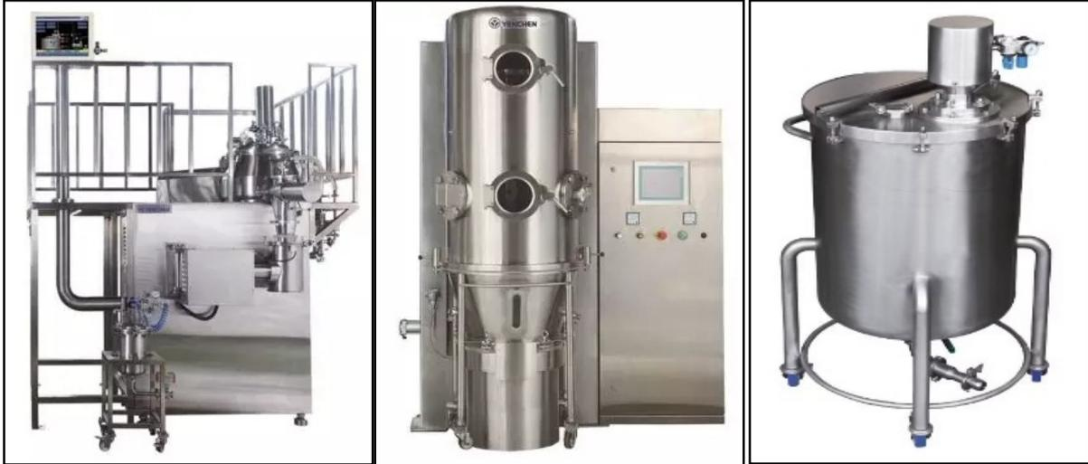
**Figure 11** : Equipements de granulation.
