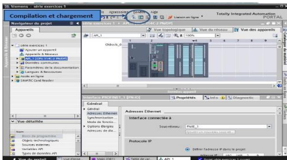
Figure 9: compilation et chargement de la configuration de la CPU
