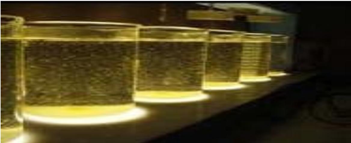
**Figure III.7 : Essai de coagulation dans une usine de traitement.**
