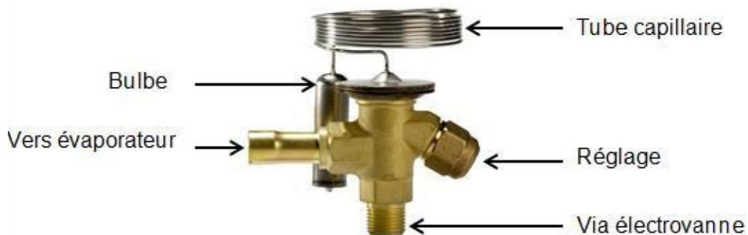
Figure 1 .6 : Détendeur thermostatique
