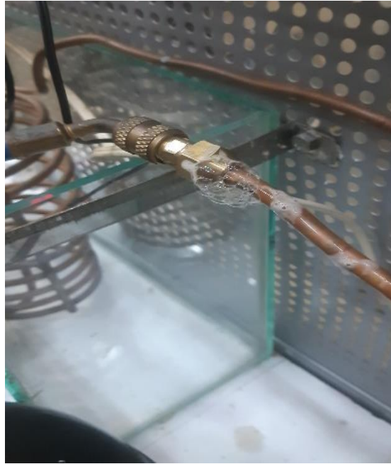
Figure. 4.41 : L'apparition de bulles savonneuses
