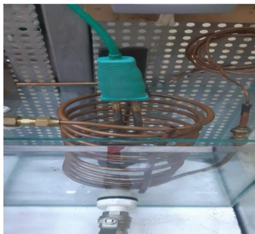
Figure 4.21: Installation d'une résistance électrique à l'intérieur d'un réservoir
