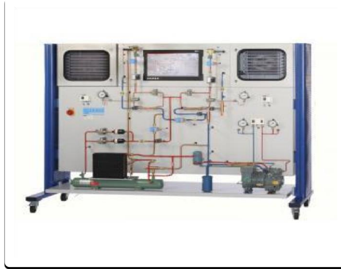
Figure 4.2 : Installation frigorifique avec régulation de puissance
