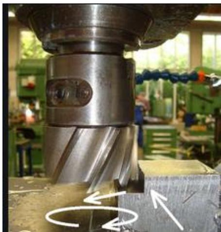
Figure I. 26Vitesse de coupe dans l'usinage de la fraiseuse.
