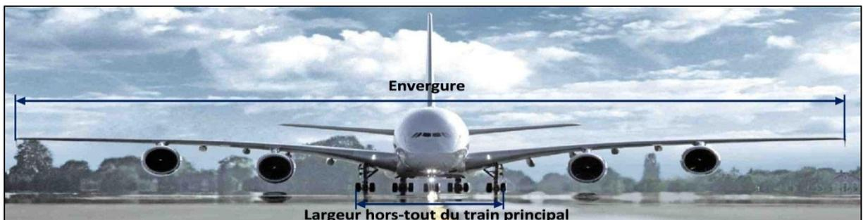
Figure 1.5: Envergure et largeur hors-tout du train principal d'un avion
