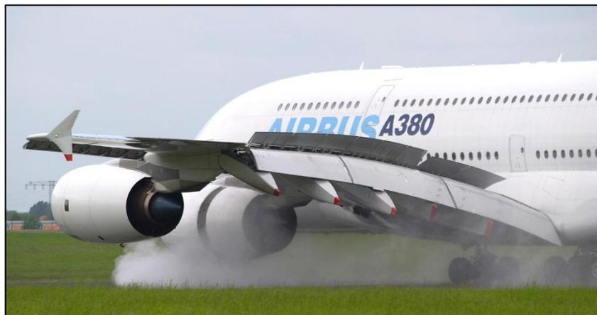
Figure 5.42 : Inversion de poussée avec les réacteurs intérieurs de l'A380
