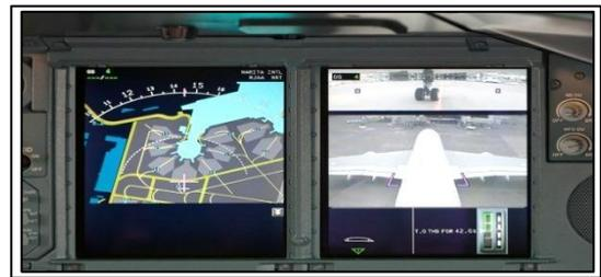
Figure 5.46 : Vues des caméras externes dans le cockpit de l'A380
