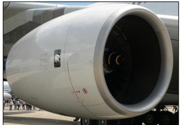
Figure 3.24: Trent 900- réacteur de Rolls Royce
