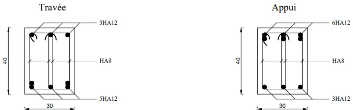
Figure IV.15. Schéma de ferrailages des poutres non porteuses du 8<sup>ème</sup> étage.
