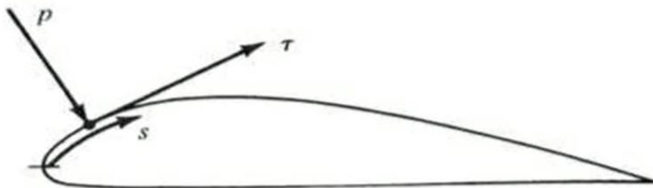
Figure I.5 : Distribution de la pression et de la contrainte de cisaillement sur la surface du corps [9]
