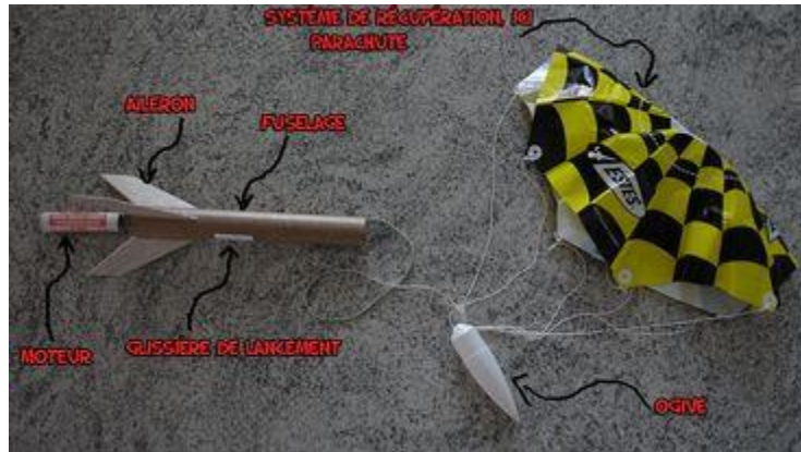
Figure I-7 : Système de récupération (parachute) [16]
