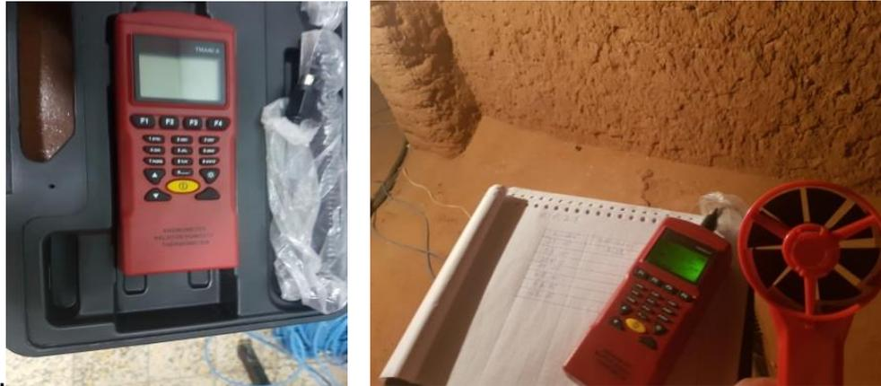
Figure 2.38: Instrument utilisé pour mesure du taux d'humidité
