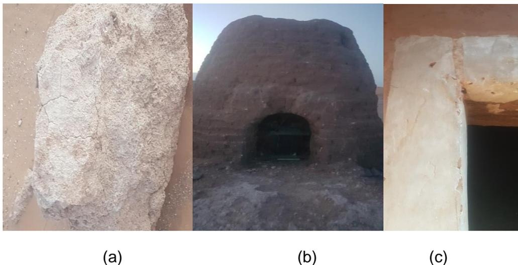
**Figure 1.7: fabrication du plâtre du gypse : (a) la roche Tefza,(b)four de cuisson,(c)peinture du linteau de la porte [ source auteur]**
