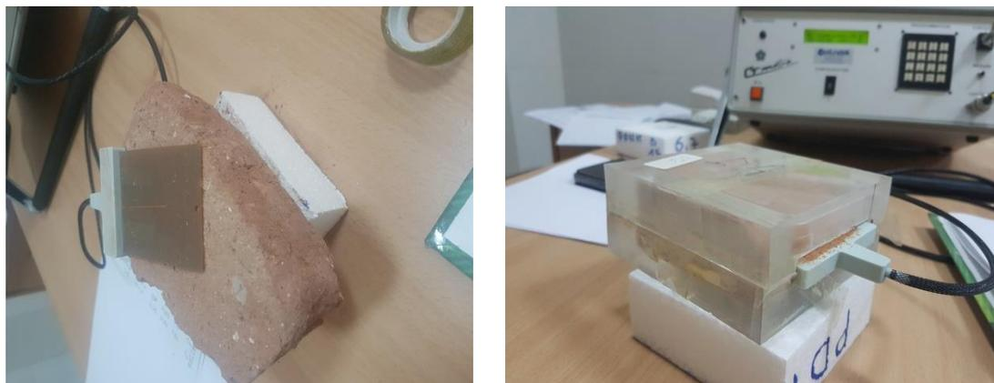
**Figure 2.27: Mesures effectuées à l'aide du CT-metre**
