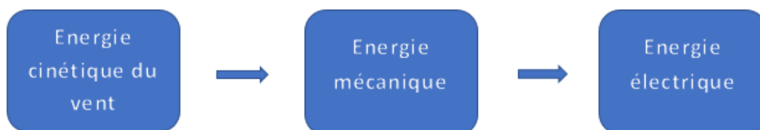
FIGURE 1.1 – conversion de l'énergie cinétique du vent.
