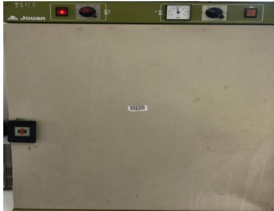
**Figure 14: Enceinte thermostatée réglée à 37.8c°.**
