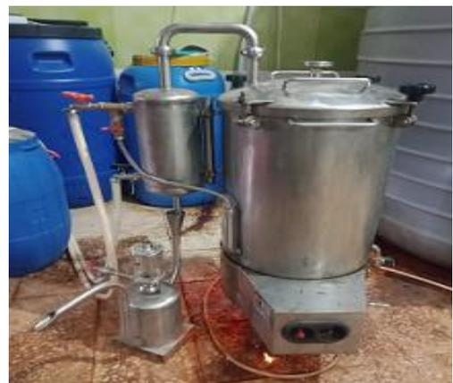
Figure 29: Appareil d'extraction des huiles essentielles type alambic distillateur INOX
