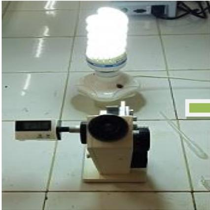
Figure 32: Direction de réfractomètre vers la lumière à l'aide d'une lampe.
