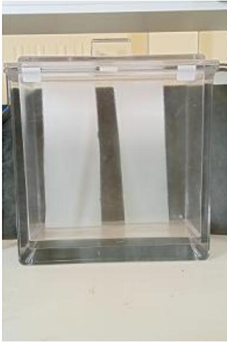
Figure 36: Plaque de silice dans l'éluant
