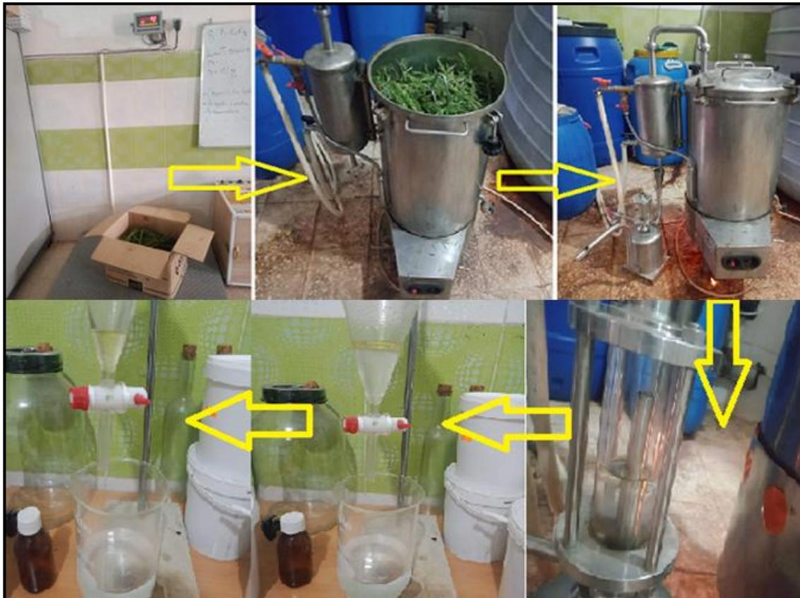
Figure 31: Procédés d'extraction de l'HE de *Rosmarinus officinalis* par l'appareil d'extraction des huiles essentielles type alambic distillateur INOX
