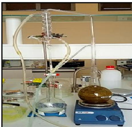
Figure 28: Dispositif d'extraction des huiles essentielles type Clevenger
