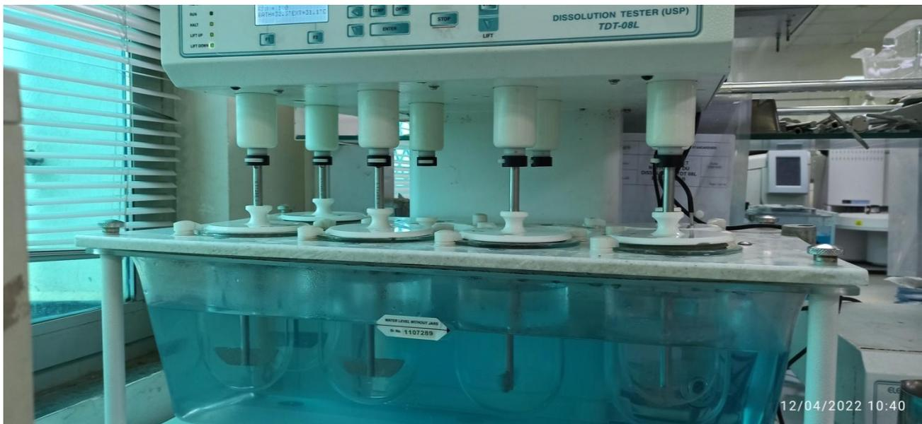
**Figure 19:** le dissolutest utilisé dans le test de dissolution.
