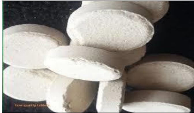
Figure 28 : Ebrèchement des comprimés. (24)
