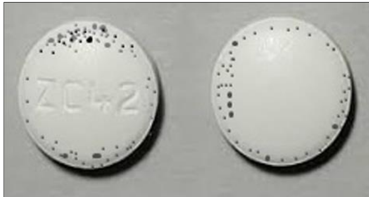
Figure 30 : Présence de points noirs dans des comprimés. (24)
