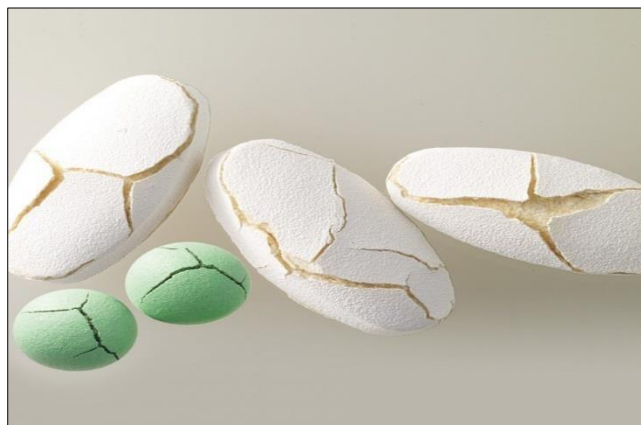
Figure 25 : Craquèlement des comprimés. (24)
