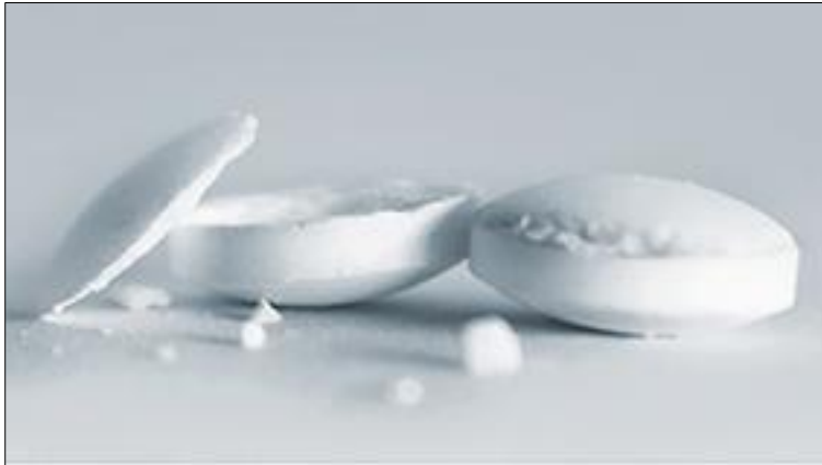
Figure 26: Décalottage des comprimés. (24)
