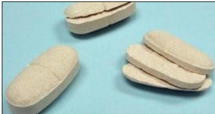
Figure 29 : Laminage des comprimés. (24)
