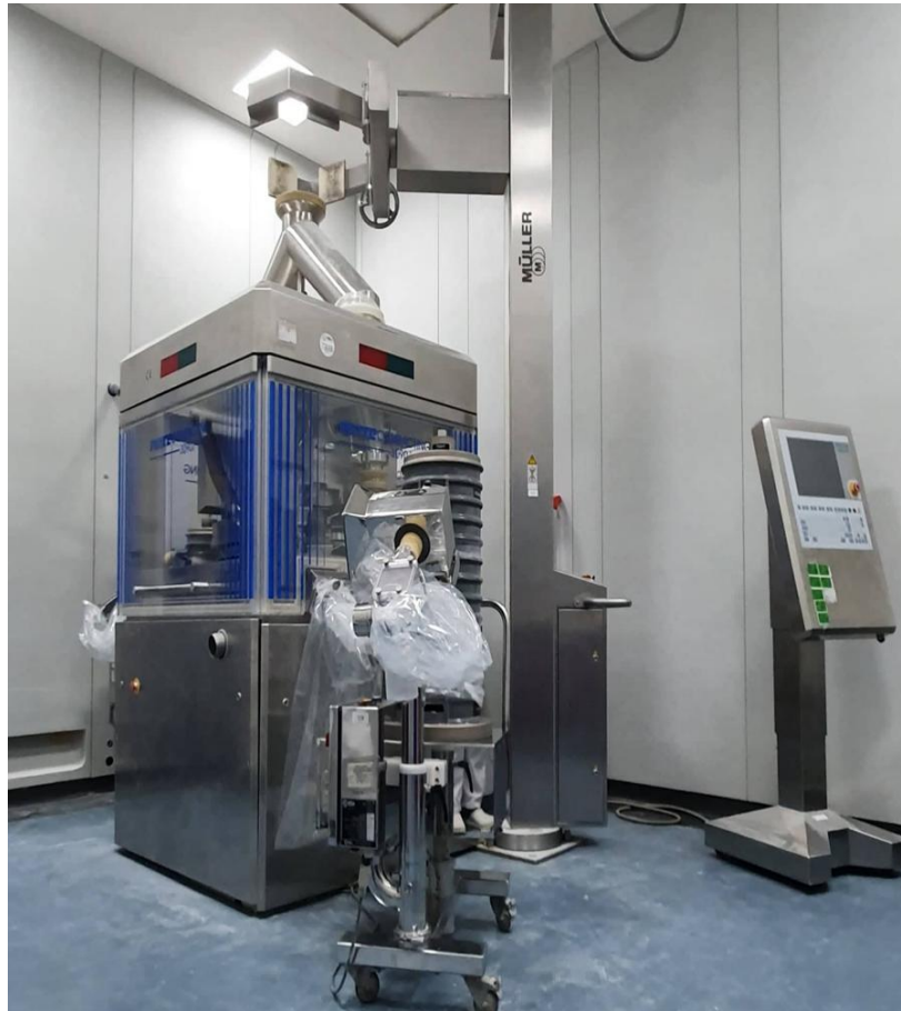
Figure 23 : Presse rotative à double station « FETTE COMPACTING 3090i ».
