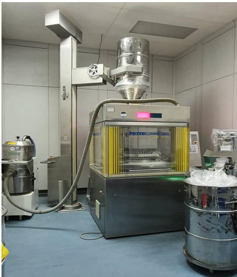
Figure 22 : Presse rotative à une seule station « FETTE COMPACTING 2200i ».
