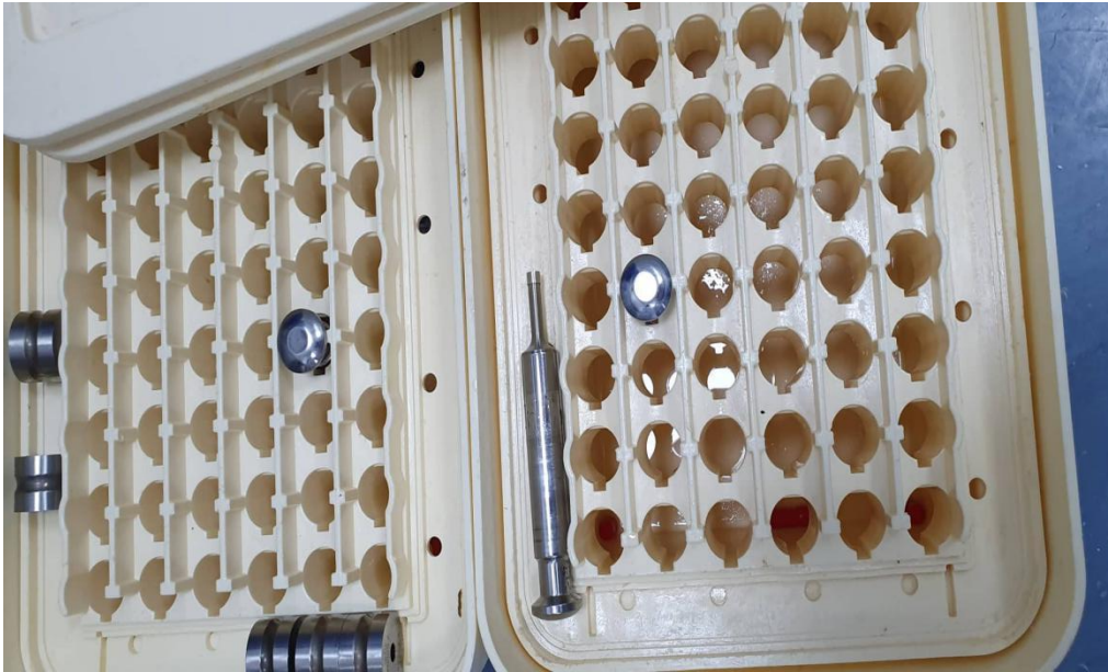
Figure 26 : Bac de stockage des poinçons au sein de l'industrie pharmaceutique « El Kendi ».
