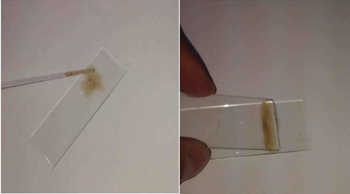
**Figure n°11:** dépôt d'une gouttelette d'échantillon et étalement sur la lame.
