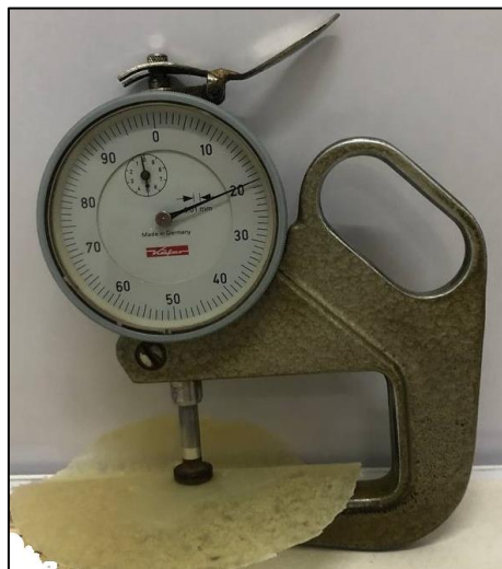
Figure V.6 : Mesure de l'épaisseur à l'aide d'un micromètre.
