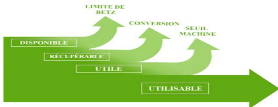
**Figure 3.1** Dégradation de l'énergie avant l'utilisation.
