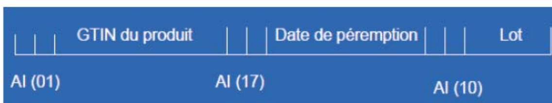
Figure 21 : Schéma d'un code GS1 couramment retrouvé sur les DMI
