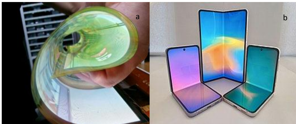
Figure 1.14 : (a) Ecrans souples à Oled de 18 pouces produit par Sumsung peut être enroulé en un cylindre de 3 cm de rayon, (b) Smart phone pliable [24].
