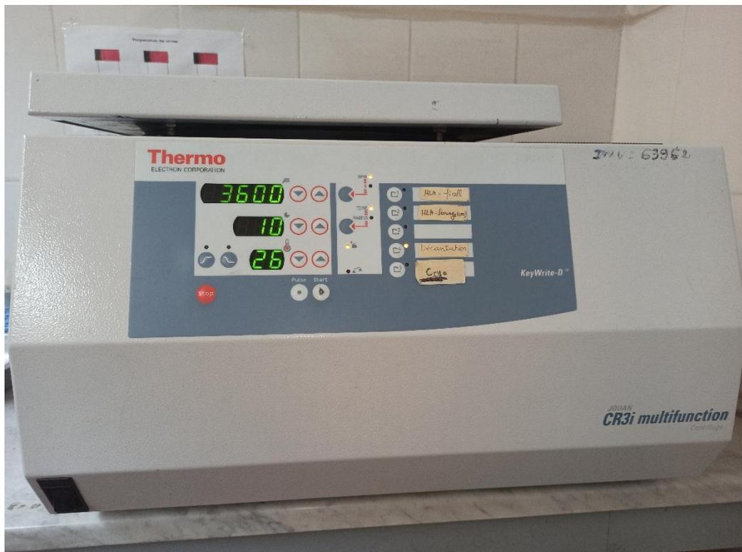
Figure 25 : Centrifugeuse Jouan type CR3i.
