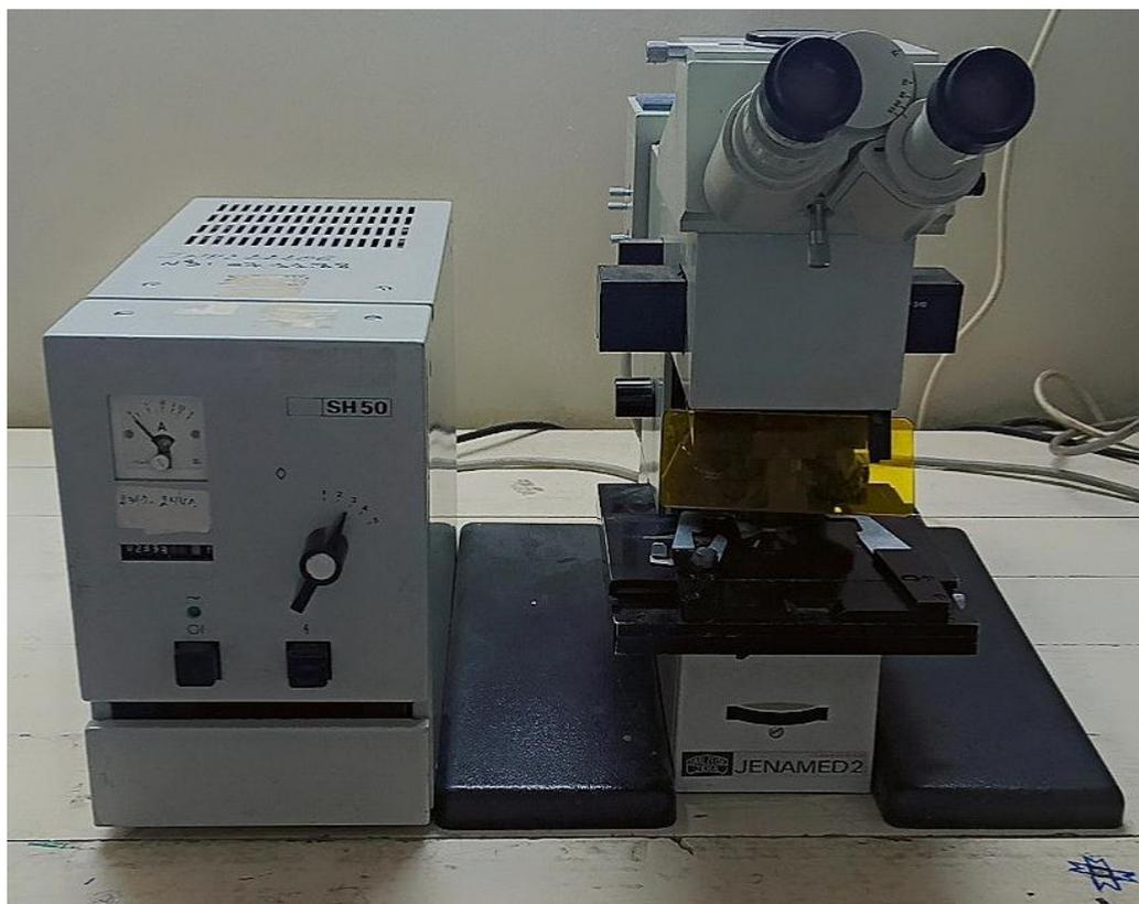
Figure 23 : Microscope à fluorescence type Jenamed 2 Carl Zeiss.
