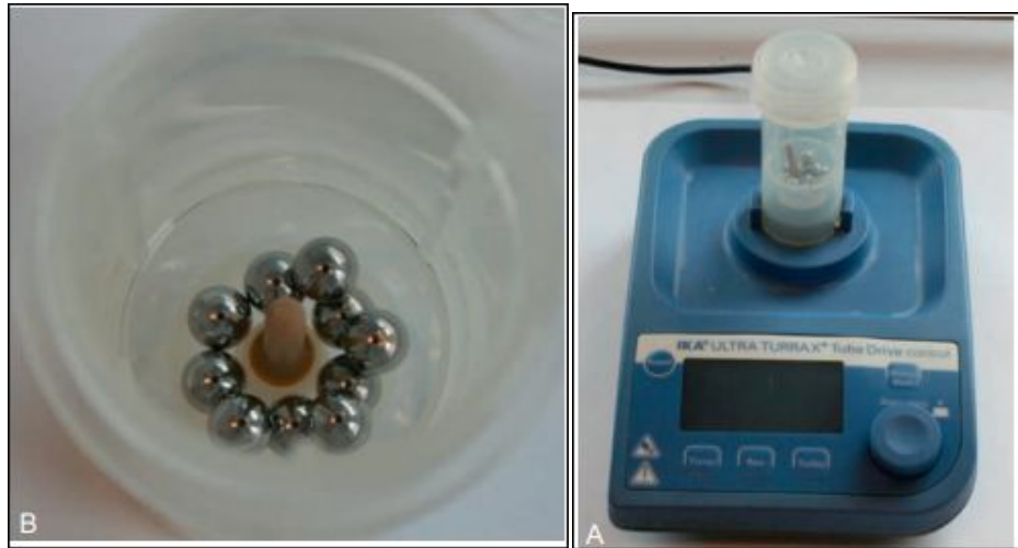
Figure 21 : Exemple de broyeur-homogénéisateur Ultra-Turrax® (A) de paillasse avec un tube à billes métalliques, (B) adapté pour les prélèvements solides ou de matériel étranger explanté (exemple vis) [88].
