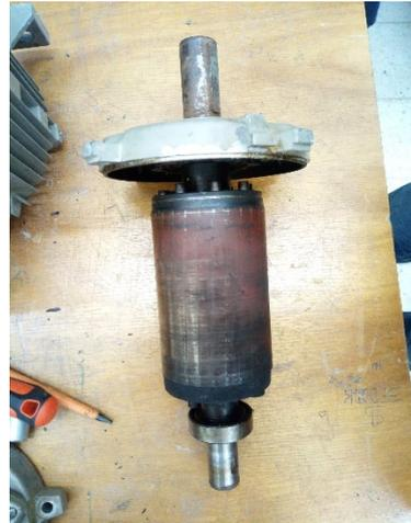
**Figure 8 :** Rotor à cage d'écureuil
