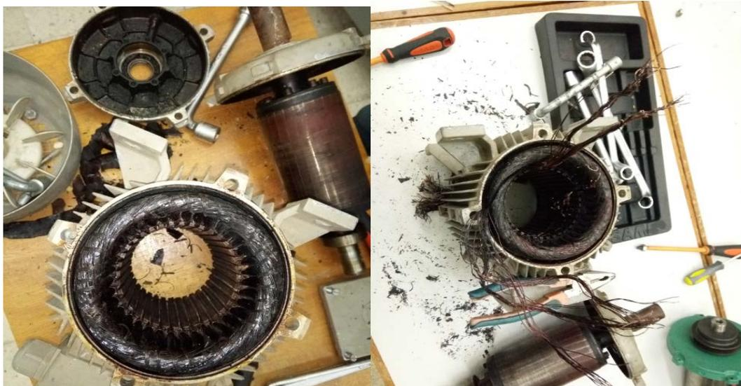
Figure 4.1 : Moteur endommagé
