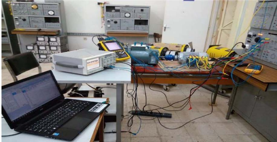
Figure 4.5 : Le banc d'essais comprenant le moteur, génératrice et les appareils de mesures
