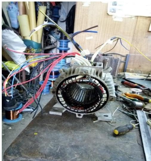
Figure 4.3 : Moteur bobiné
