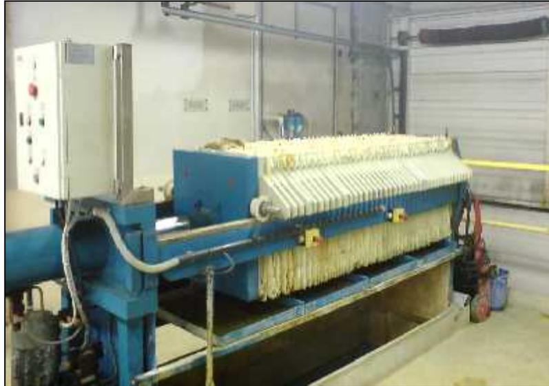
**Figure I.6 :** Photo d'un filtre-presse (filtration sous pression). [i]
