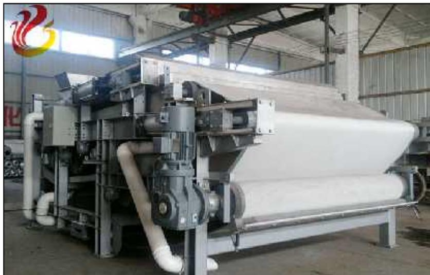
**Figure I.7 :** Photo d'un filtre à bande (filtration sous pression). [j]
