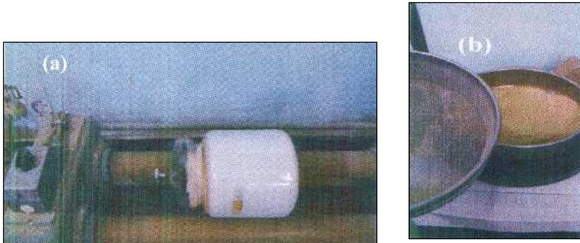
**Figure II.7 :** (a) Photographie d'un broyeur de laboratoire, (b) La poudre de cactus après broyage et tamisage.
