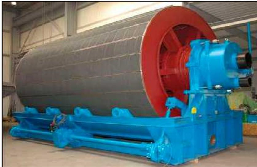
**Figure I.5 :** Photo d'un filtre à tambour rotatifs (filtration sous vide). [h]
