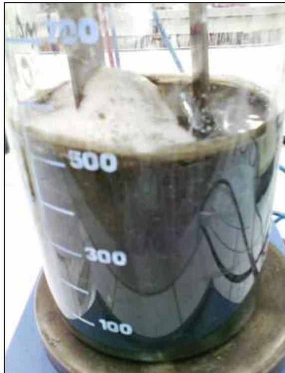
**Figure III.25 :** Photo obtenue après électrocoagulation avec biofloculant.  $i = 100 \text{ A.m}^{-2}$ ,  $T = 15 \text{ min}$  et  $D = 0.5 \text{ g/kg}$ .
