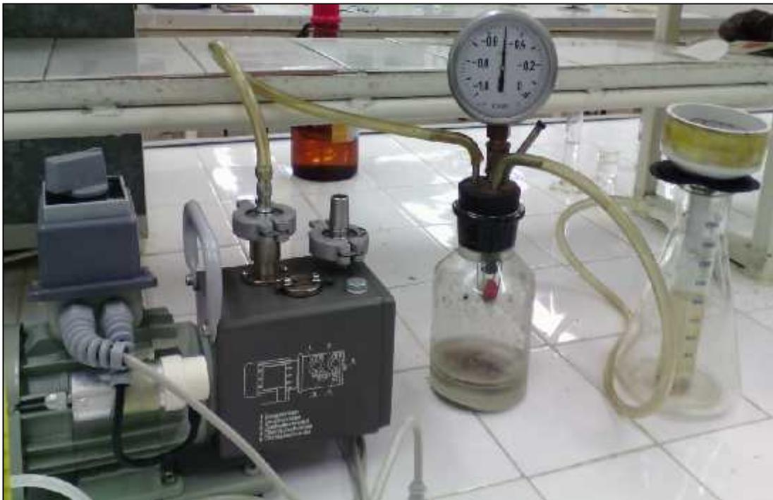
**Figure II.3 :** Photo de montage expérimentale de la filtration sous vide.
