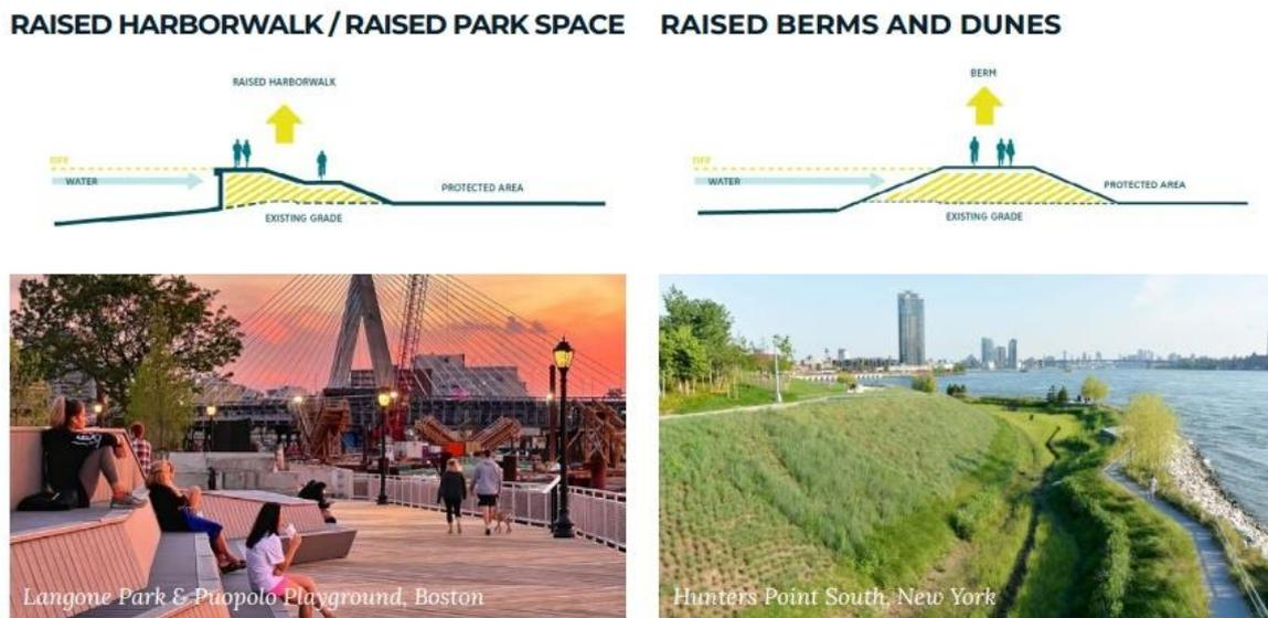
Figure 95: Elévation de la promenade portuaire et du parc à gauche et élévation des dunes et bermes à droite. Source: In coastal resilience solutions for east Boston and Charlestown phase 2, 2022
