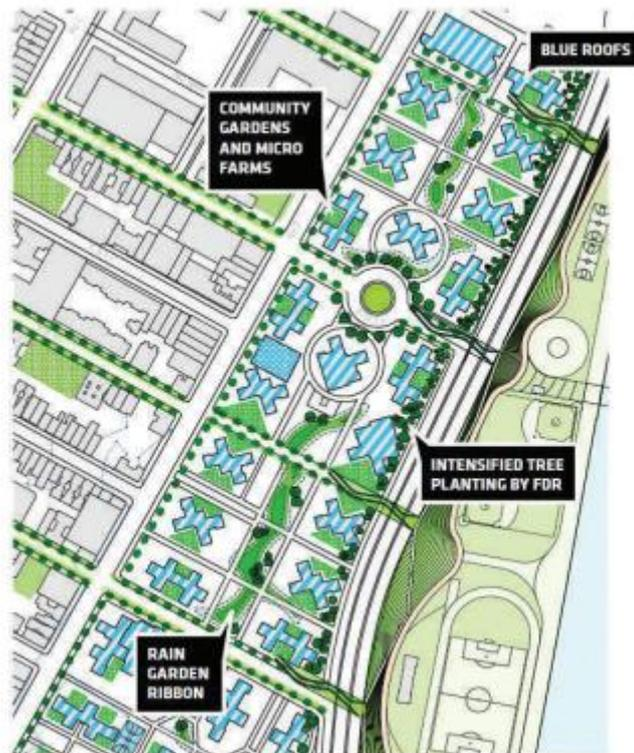
Figure 91: Le déploiement d'infrastructures vertes dans l'ensemble des campus de logements publics afin de gérer les eaux pluviales et de réduire les risques d'inondation. Source : Grannis et al. (2016)
