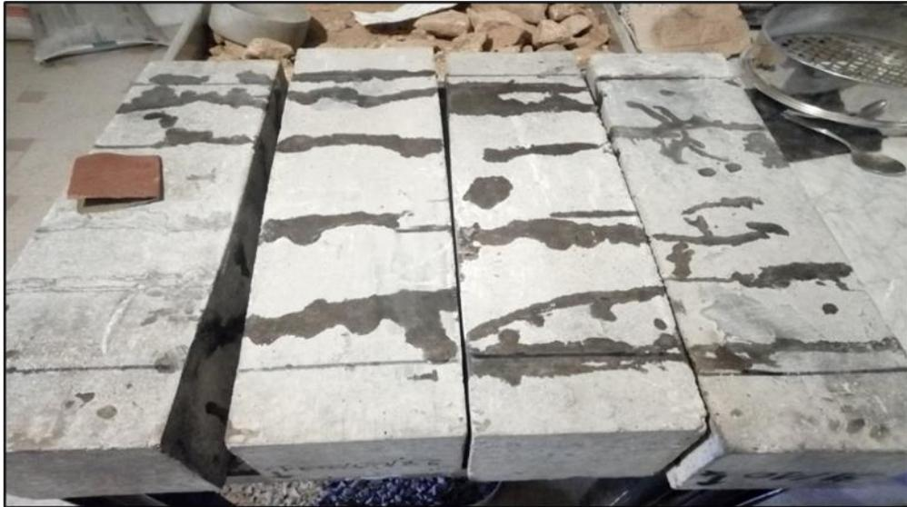
Figure II.28 Vue des poutres endommagées puis réparées
