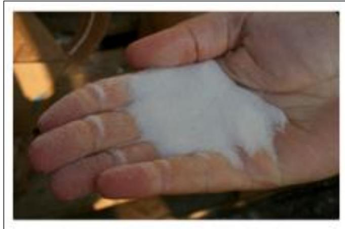
Figure I.21 Microbilles creuses en verre [34]
