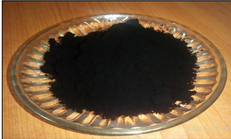
Figure II. 8 Nanotubes de Carbone à parois multiples (en poudres)
