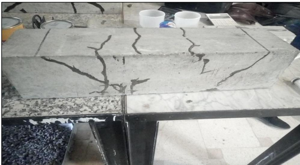
Figure II.29 Poutres après injection des fissures par Sikadur 52
