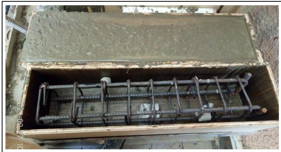
Figure II.22 Coffrage et procédure de coulage des poutres
