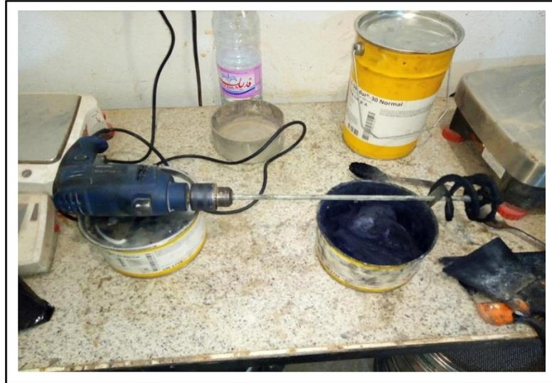
Figure II.23 Mixage des composants A et B de la résine Sikadur 30.
