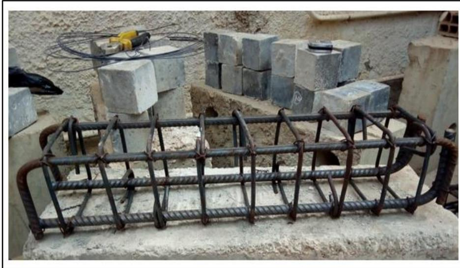
Figure II.21 Ferrailage des poutres d'essai
