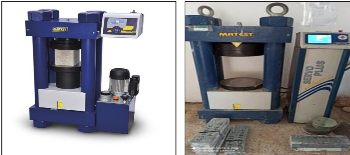
Figures II.13 et II.14 Vues de la machine de compression ‘MATEST’ 3000 kN
