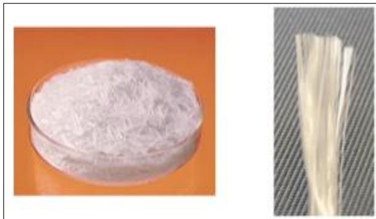
Figure I.22 Renforts en verre (fibres courtes et fibres longues) [34]
