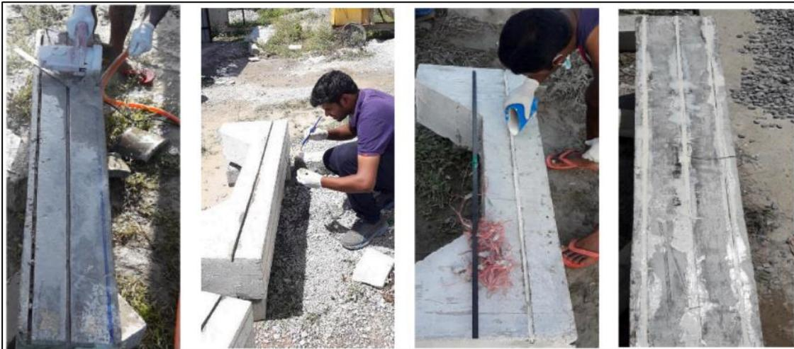
Figure I.26 Utilisation de la technique "Montage en Surface" des FRP [41]
