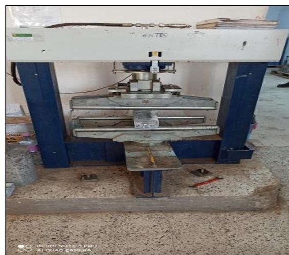
Figures II.11 et II.12. Vues de la Machine de flexion 04 points MATEST (200 kN)
