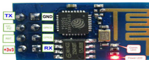
Figure 3.14. Description des broches du module ESP8266-01
