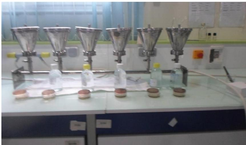
Fig.2. 13 . *Système de filtration sur membrane.*
