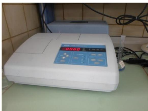
**Fig.2. 5 . Turbidimètre.**
