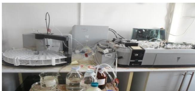
*Fig.2. 9 .Appareil de mesure de Nitrate.*
